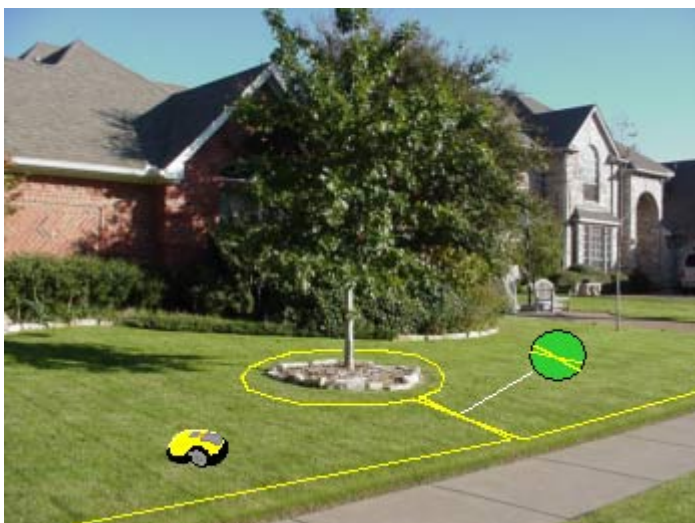
Abbildung 3 - Falsche Installation einer Insel
