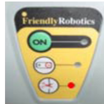
Abbildung 1 Die Anzeige für den unterbrochenen Draht blinkt
